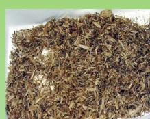
Poda de olivo pretratada por oxidación alcalina 1% H<sub>2</sub>O<sub>2</sub>, pH 11,5 (NaOH)
